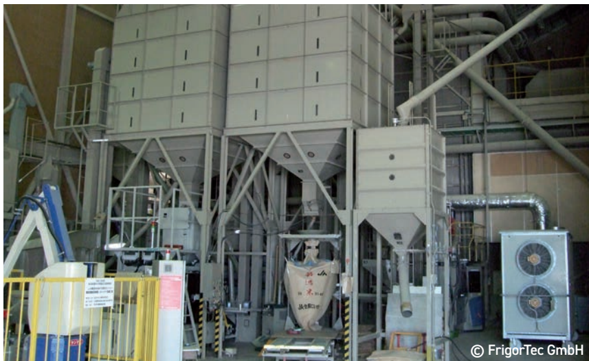
13 Silo de arroz blanco con GRANIFRIGOR™ equipo de refrigeración en un molino de arroz.
